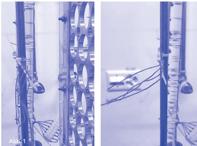
Simulationen des Trocknungsprozesses anhand eines Prototyps: Die Fäden zeigen den Luftstrom der aktivierten EHD-Technologie
