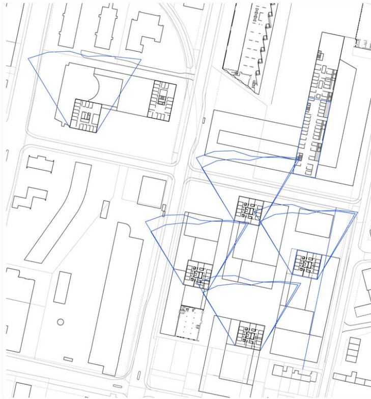
Abbildung 1.99: Schattenwurf Hochhäuser 2h / 2.5h, Studienverfahren (Die Hochhäuser Baufeld 5-8 sind in den Szenarien 1-3 etwas breiter, dadurch ist der 2-h-Schatten dort leicht grösser).
